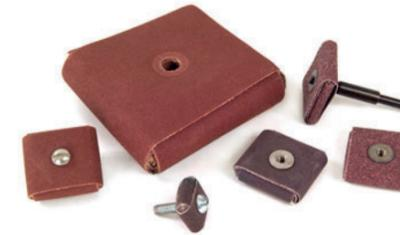
Les tampons carrés sont utilisés pour le sablage des soudures, la finition ID et l'ébavurage de surfaces planes. Peuvent être fabriqués avec d'autres minéraux. Standards avec œillet fileté.
