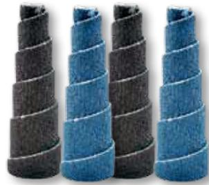
Ce sont des rouleaux abrasifs dont les arêtes coupantes se régénèrent au fur et à mesure que la toile s'use. L'outil idéal pour l'enlèvement des cordons de soudure et des marques, la finition des rebords et le ponçage des cavités. Il permet d'atteindre des endroits qui sont habituellement inaccessibles.
