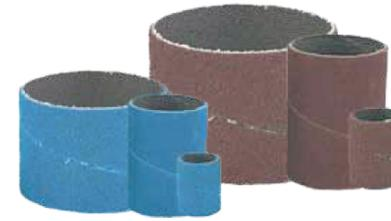
Les manchons en spirale sont composés d'une toile abrasive de première qualité enroulée et fixée sur une toile résistante. Cette conception en spirale assure un ponçage lisse et uniforme. Les manchons en spirale sont excellents pour l'ébavurage et la finition des bordures, des formes profilées, des soudures, des alésages, etc.
