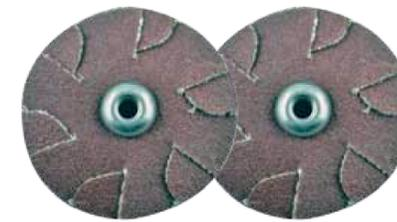
Idéals pour l'ébavurage et le polissage des rayons et des alésages ainsi que l'intérieur des cylindres. Les disques à quatre épaisseurs s'utilisent dans un mouvement vers l'intérieur seulement.
