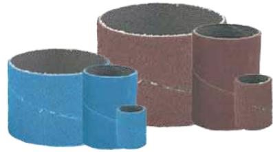
Les manchons en spirale sont composés d'une toile abrasive de première qualité enroulée et fixée sur une toile résistante. Cette conception en spirale assure un ponçage lisse et uniforme. Les manchons en spirale sont excellents pour l'ébavurage et la finition des bordures, des formes profilées, des soudures, des alésages, etc.
