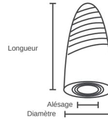
Ce sont des rouleaux abrasifs dont les arêtes coupantes se régénèrent au fur et à mesure que la toile s'use. L'outil idéal pour l'enlèvement des cordons de soudure et des marques, la finition des rebords et le ponçage des cavités. Il permet d'atteindre des endroits qui sont habituellement inaccessibles.
